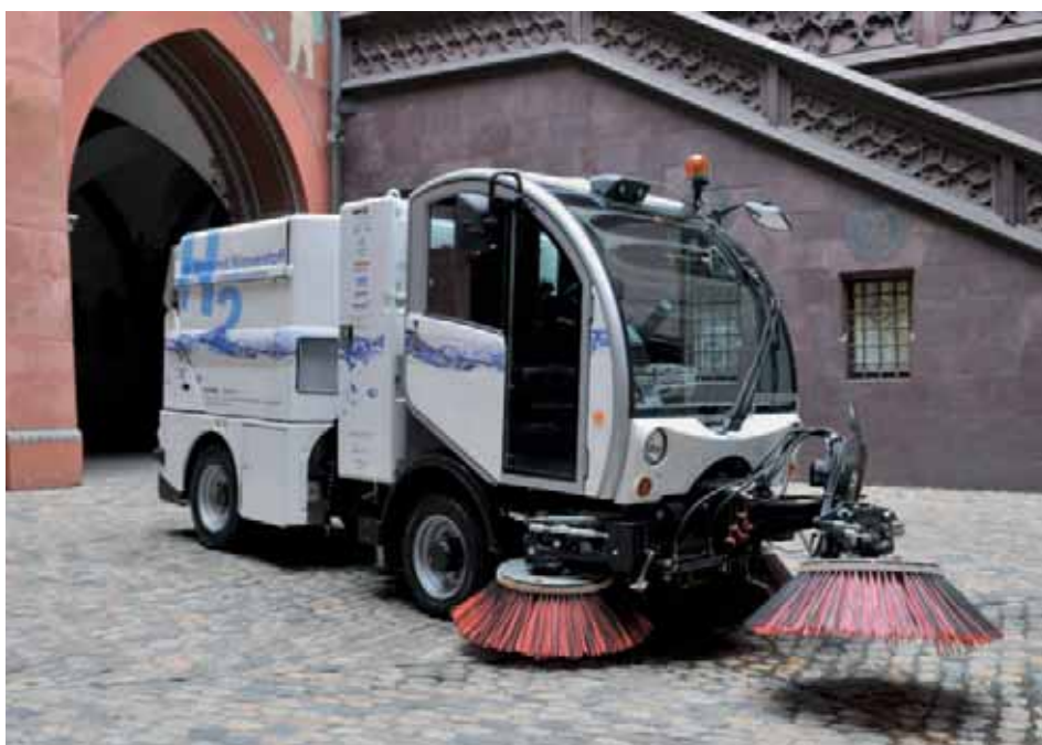
Die Kehrmaschine «Bucher Schörling CityCat H 2 » auf den Strassen von Basel: Das weltweit erste Kommunalfahrzeug mit Brennstoffzellenantrieb verbrauchte in der ersten Projektphase im Schnitt nur halb so viel Treibstoff wie ein konventionelles Fahrzeug. (Bild: Juri Weiss)
